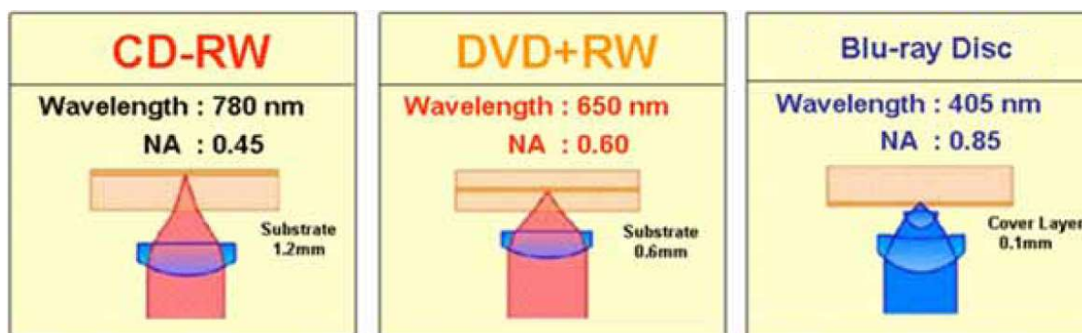
Figura 3.8.6 – Longitud de onda. Comparativa entre CD, DVD y Blu-ray
