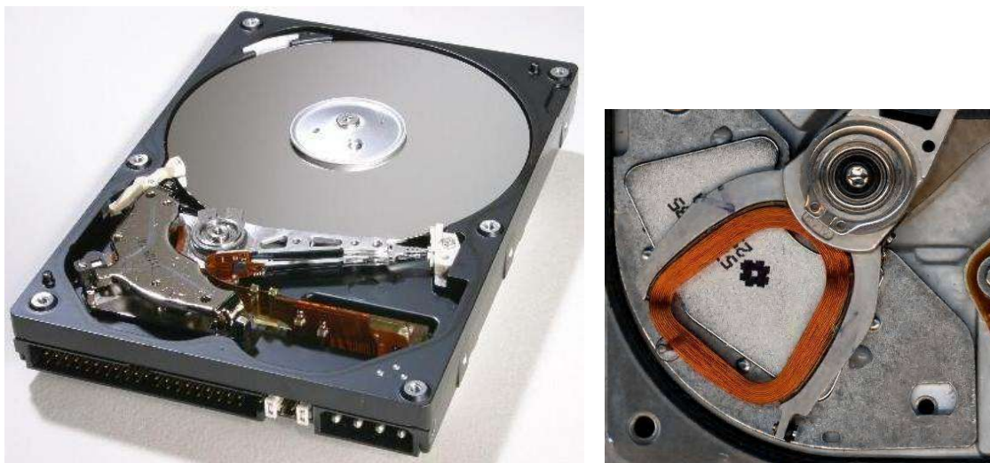
Figura 3.5.3 – Interior y detalle del motor de accionamiento de las cabezas
