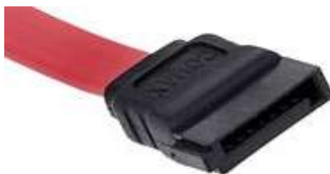
Figura 3.2.5 – Conector de la interfaz SATA
