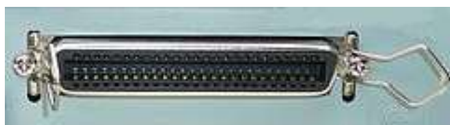
Figura 3.2.3 – Conector de la interfaz SCSI
