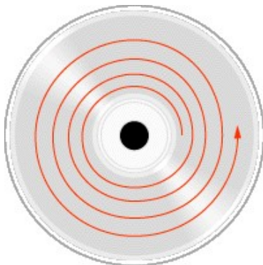
Figura 3.8.1 – Pista en espiral
